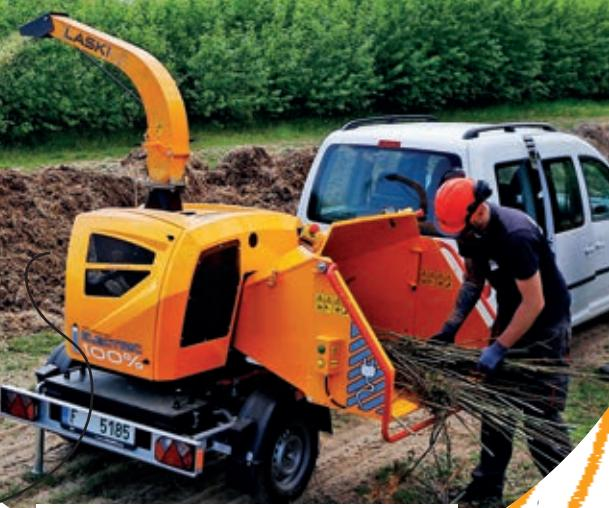
Štěpkovač LS 160 AB je první plně elektrický kompaktní stroj na baterie určený k likvidaci dřevního odpadu, větví s listím i jehličím, kmenů a dalších nadzemních částí rostlin do průměru až 160 mm. Štěpkovač je bezemisní a neobsahuje žádnou hydraulickou kapalinu, nepotřebuje tudíž ani gram oleje. Jako zdroj energie jsou použity robustní akumulátory technologie lithium-železo o bezpečném napětí 48 V. Unikátnost stroje potvrzuje patent č. 308575 udělený Úřadem průmyslového vlastnictví.
